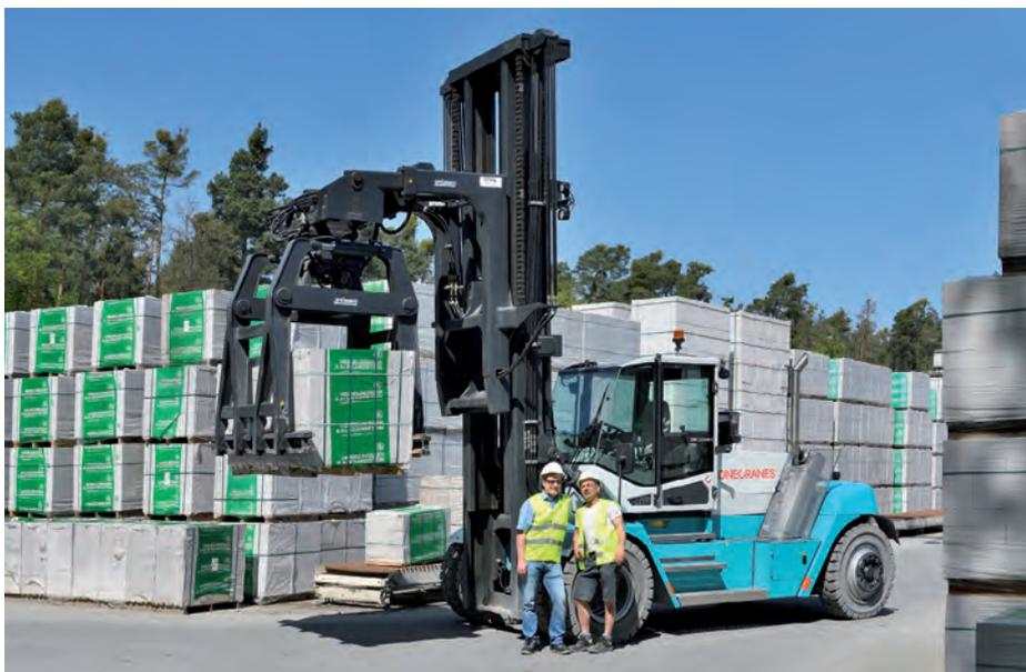
geräusch- und vibrationsgedämpften Optima Kabine mit Klimaanlage, DAB-Radio und 7-Zoll-Touchmonitor haben die Fahrer ihre Maschine bestens im Blick und steuern sie per Joystick.
